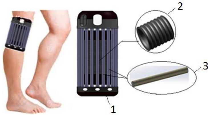
Նկ. 3.32. ա) Օրթեզի կիրառությունը. 1) օրթեզ, 2) առաձգական հոդ, 3) ակտուատոր
