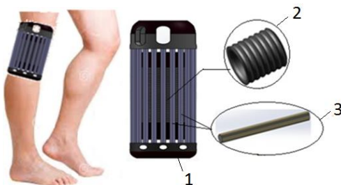
Рис. 5. Применение ортеза: 1 - ортез, 2 - упругий сустав, 3 - актуатор
