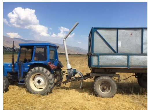
Նկ.2.1 Մղեղի հավաքման պնևմատիխակրիչի տեխնոլոգիական սխեմա և փորձնական նմուշի լուսանկարը: 1-օդամղիչ, 2-մղող օդատար, 3-նեղծծող ճկափող, 4-էլեկտրաշարժաքեր,
