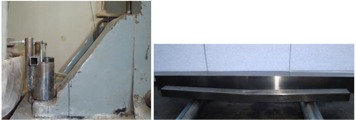
Նկ. 3.43. Քառակուսի հատույթով պողպատե հեծանի տեղակայումը ստենդում և փորձի արդյունքում դրա դեֆորմացված տեսքը
