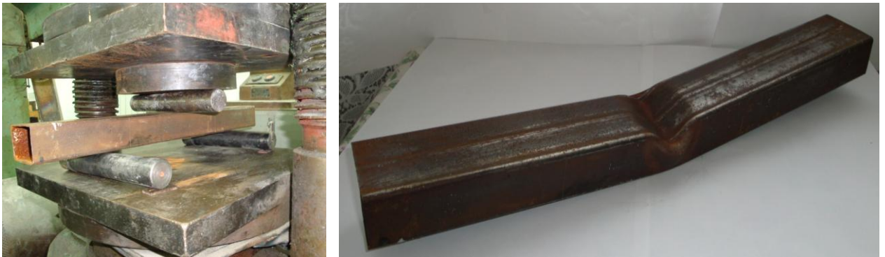
Նկ. 3.38. Պողպատե ուղղանկյուն հատույթով հեծանի տեղակայումը մամլիչում և փորձի արդյունքում դրա դեֆորմացված տեսքը
