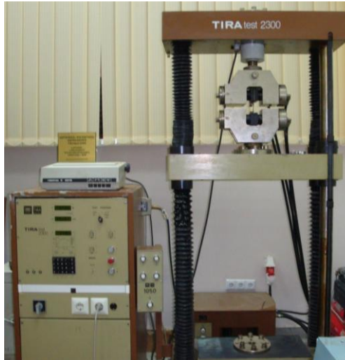
Նկ. 3.28. TIRAtest 2300 փորձարկման մեքենայի և կառավարման վահանակի արտաքին տեսքը
