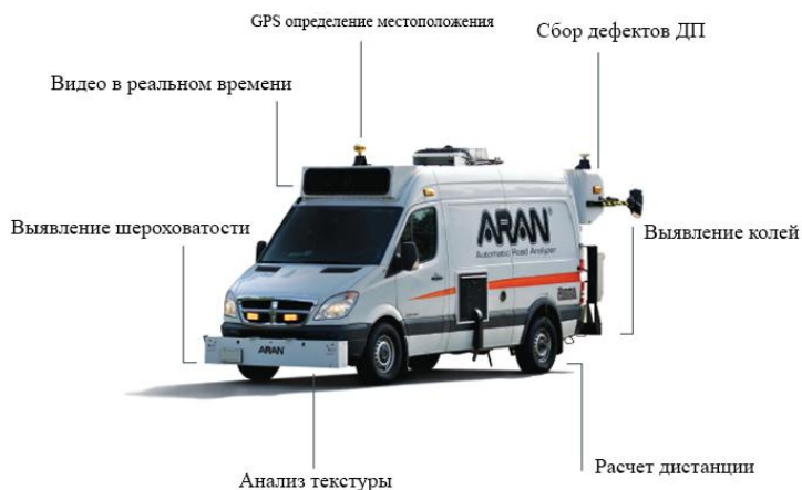
Рис. 2. Пример существующей автоматизированной системы контроля качества ДП (ARAN)
