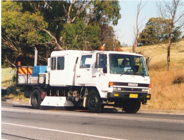
Նկ. 1.6 CSIRO RoadCrack համակարգ:
