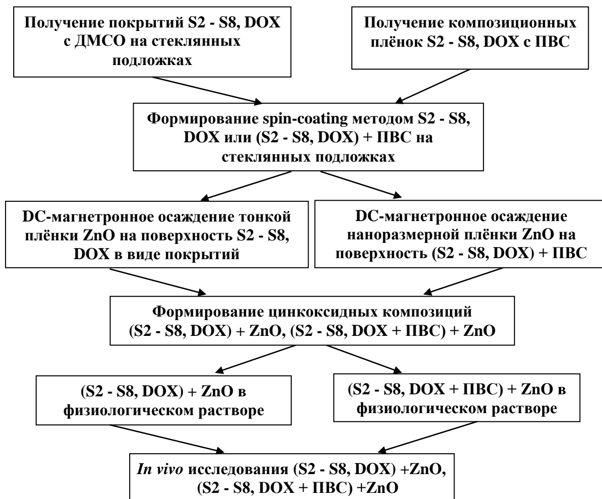
Рис. 21. Технологическая схема получения цинкоксидных композиций S2 - S8, DOX
