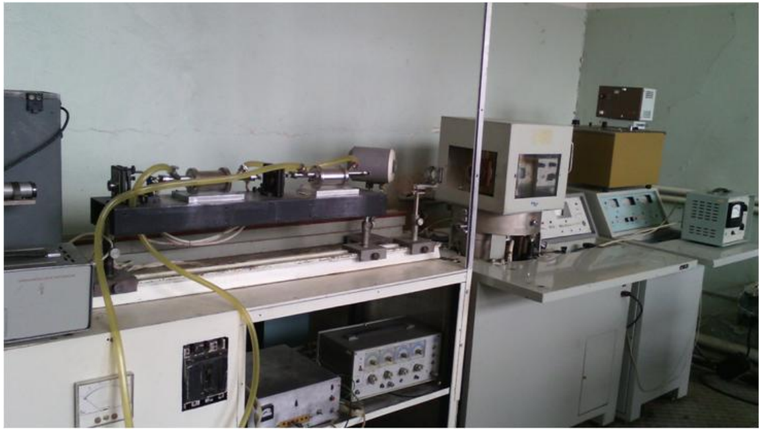
Նկ. 14. Իմպուլսային լազերային փոշեցրման համակարգի տեսքը:
