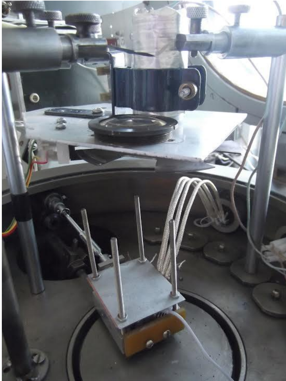
Նկ. 42. Երկչ ափկոորդինատագայ ու ն ֆոտոընդունիչների հետազոտման համար մշակված սարքավորումը:
