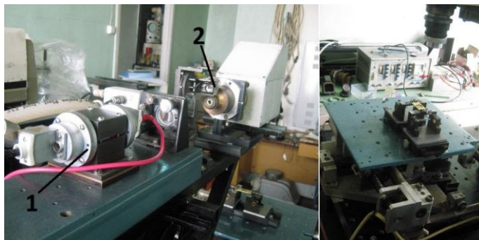
Рис. 4 Устройство автоматической обработки молибденовых мишеней лазером: слева - твердотельный лазер: 1 - лазер, 2 - расширитель пучка; справа - 2-х координатный стол с удаленным компьютерным управлением.
