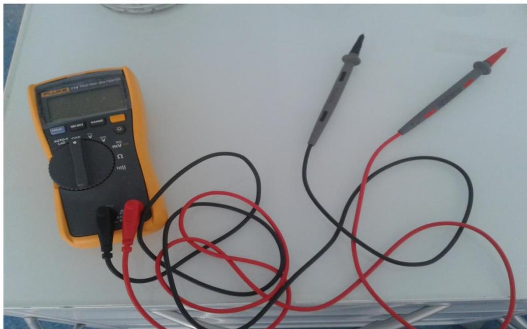
**Рис. 5.** Стационарный цифровой мультиметр Fluke 114.
