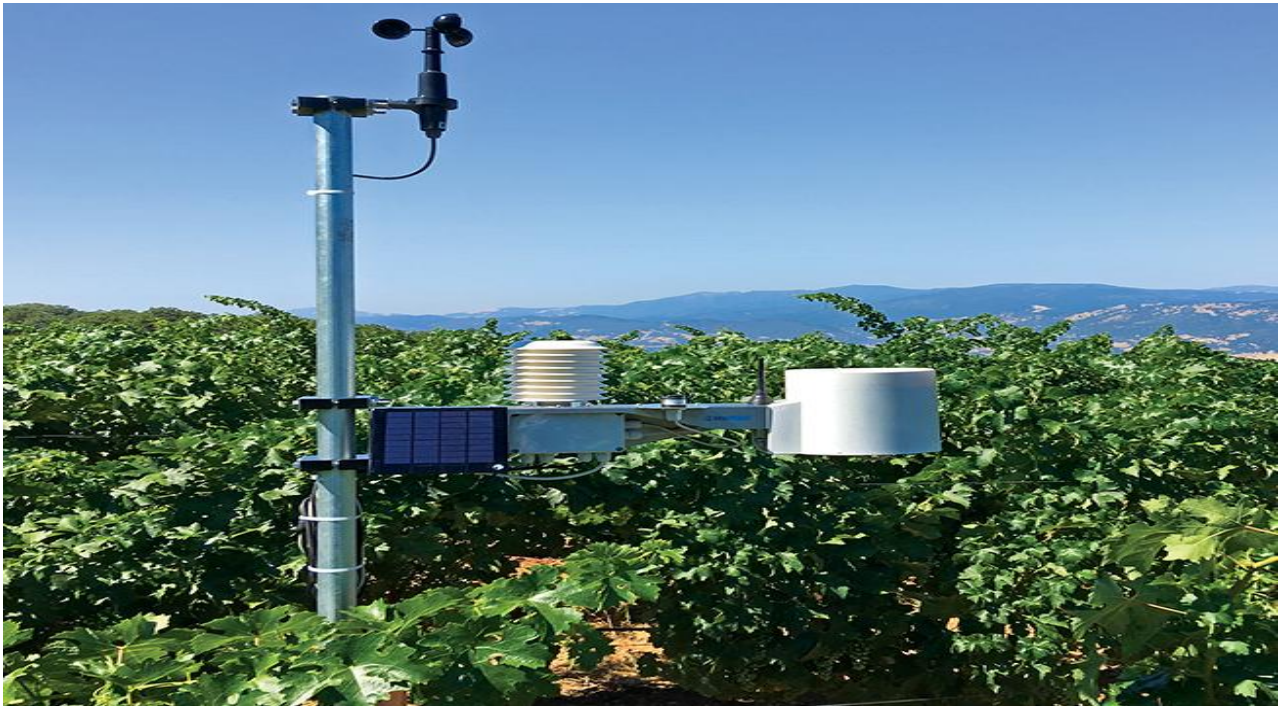
Նկար 9. Եղանակի տեղեկատվական կայան Pessl ընկերության iMETOS դասի IMT200 մոդելը
