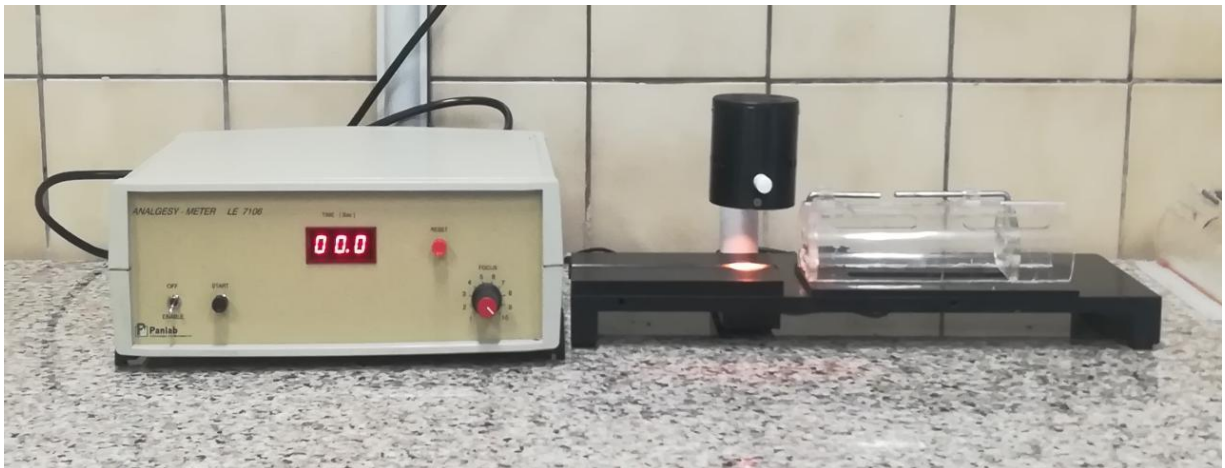
Նկար 2.2.1. Հականոցից պոչի վակտիվության որոշման «tail-flick» սարքը
