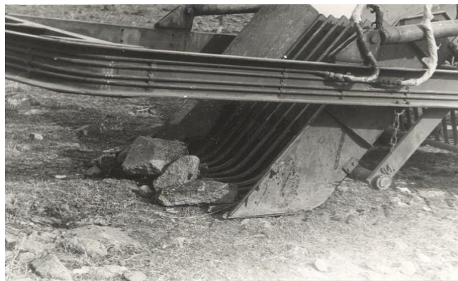
Նկ. հ. 22.3. Քարհավաք YKP-0,6 մեքենայի աշխատանքային գործընթացը պողպատե թիթեղ տեղադրելուց հետո:
