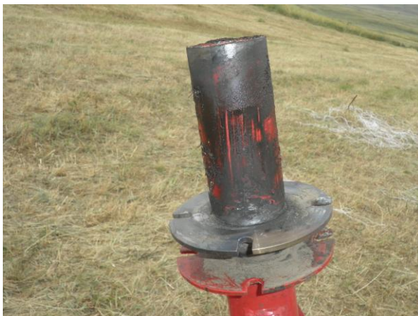
Նկ. հ. 15.1. Խոտի անիվամատնավոր “Celmak” փոցիի խափանված մեքենամասերը և նորոգու մը:
