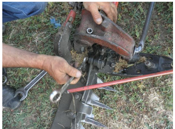
Նկ. հ. 13.1. КС-2,1Г խոտհանձնիչի խափանված մեքենամասերի նորոգումը և փոխարինումը նորոգվող աշտային պայմաններում:
