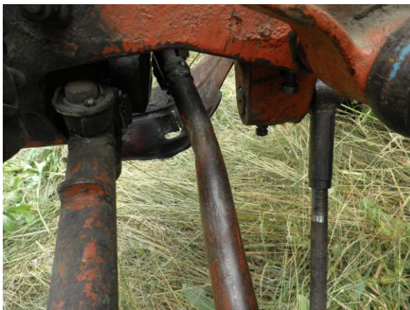
Նկ. հ. 13.1. КС-2,1Г խոտհանձնիչի խափանված մեքենամասերի նորոգումը և փոխարինումը նորոգվող աշտային պայմաններում:
