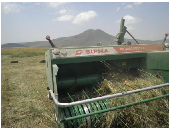
Նկ. հ. 10.1. Պրիզմա և հակերի պատրաստման “Sipma” հավաքիչ - մամլիչի ընդհանուր տեսքը տարբեր աշխատանքային դիրքերում:
