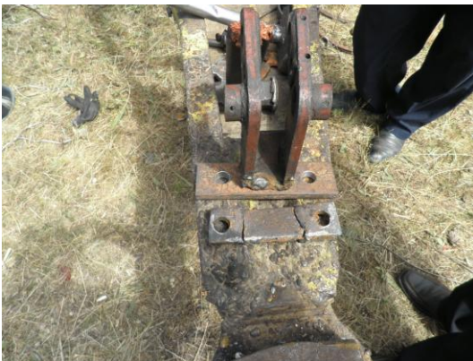
Նկ. հ. 5.2. Holland 55-56 (FD-2,10) հնձիչի մոտ խափանումների բնութագրական պատկերները:
