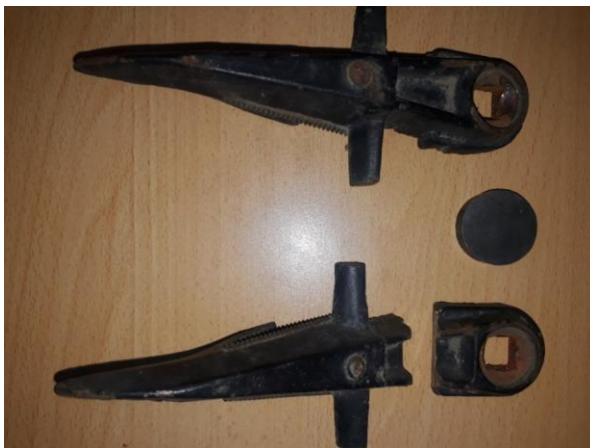
Նկ. 4.23. Խոտհնձիչ մեքենայի մատները (ջարդված և չջարդված տեսքով) միջանկյալ մասում պատկերված է 35 L պողպատից ձուլմամբ պատրաստված նմուշ (վկա), որն օգտագործվում է ջերմաքիմիական մշակման ընթացքում հետազոտության
