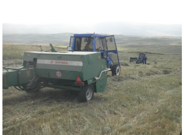
Նկ. հ. 10.1. Պրիզմա և հակերի պատրաստման “Sipma” հավաքիչ - մամլիչի ընդհանուր տեսքը տարբեր աշխատանքային դիրքերում:
