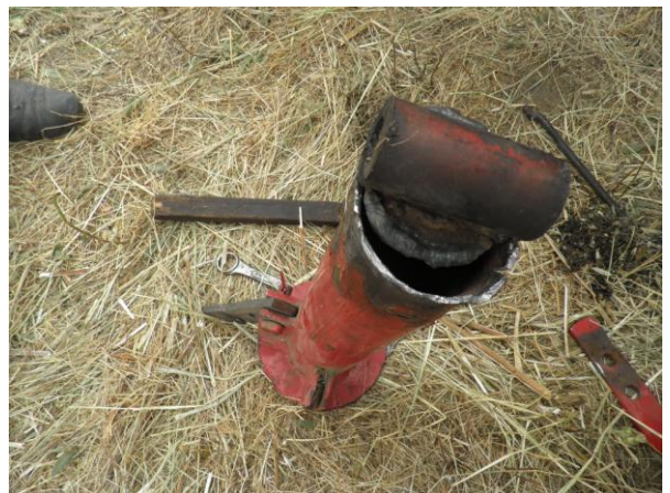
Նկ. հ. 15.1. Խոտի անիվամատնավոր “Celmak” փոցիի խափանված մեքենամասերը և նորոգու մը:
