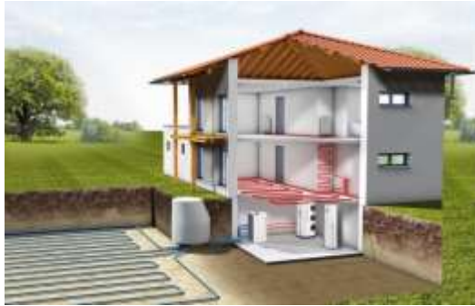
Նկ.1 Փակ ցիկլով աշխատող գեոթերմալ ջերմային պոմպի գծապատկեր
