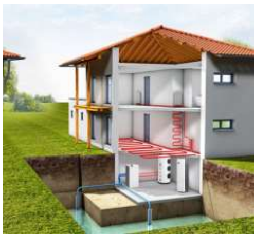
Նկ.2 Բաց ցիկլով աշխատող գեոթերմալ ջերմային պոմպի գծապատկեր
