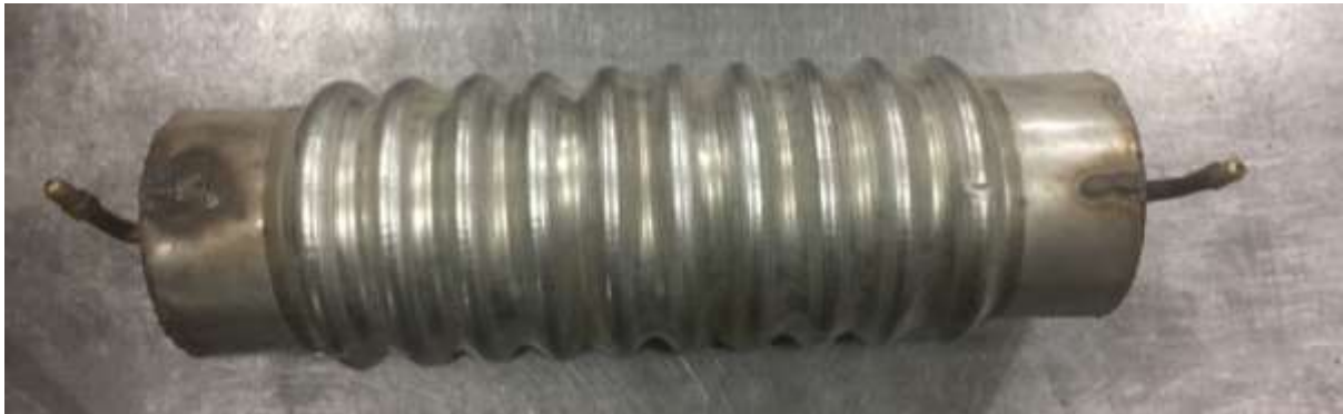
ՆԿ.8 Փոփոխական երկրաչափությամբ գոլորշացուցչի տեսքը 5,5 մթ. բարձր ճնշմամբ փորձարկելուց հետո
