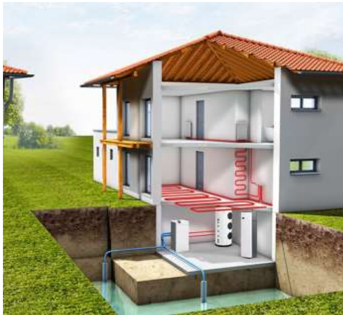
ՆԿ.4 Բաց կոնստրուկով աշխատող գերթերմալ ջերմային պոմպի գծապատկեր[62]
