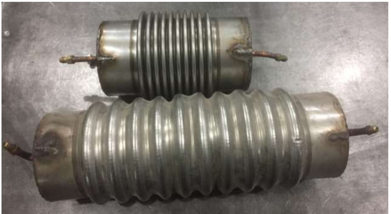
ՆԿ.9 Աշխատանքային վիճակում և պլաստիկ դեֆորմացիաների առաջացումից հետո փոփոխվող երկրաչափությամբ գոլորշացուցիչների երկրաչափական չափերի տարբերությունը
